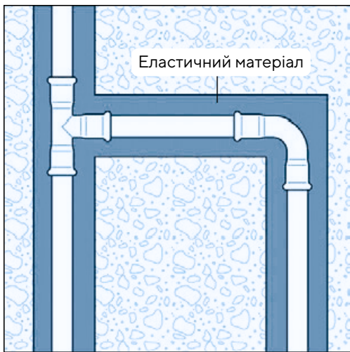
Рис. 7. Скрите прокладання трубопроводу
