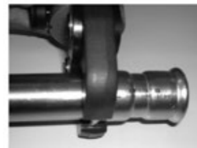
Разомкните тиски под прямым углом и зажмите. Open the jaw, place at a right angle and carry out the pressfitting.
