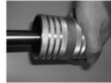
Зачистите края трубы изнутри и снаружи так, чтобы не повредить уплотнительное кольцо. Debur the tube internally and externally so as not to damage the seal.
