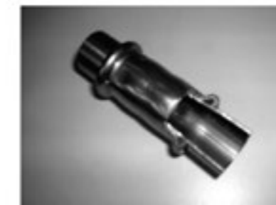
После опрессовки: продольный разрез пресс-соединения. After the pressfitting: a longitudinal section of a pressfitted joint.
